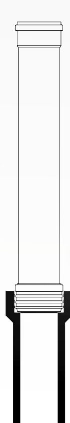
Övergång från POLO-KAL NG-rörande till fibercement-muff
